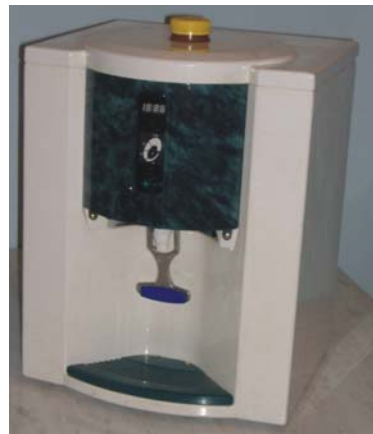
Сл.3. Прототип електрохемијског генератора за производњу активног хлора
